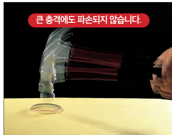
시험결과 위 그림은 1.3m 높이에서 끝이 뾰족한 500g의 쇠막대를 자유낙하시킨 결과로, 약간의 균열이 있었을 뿐 관통 및 파손되지 않았음. [KSP 8147 참조 : 45g 강구를 1.3m 높이에서 자유 낙하 시험을 함 / 보호구 자율안전 확인 고시(노동부 고시에 준함)]
